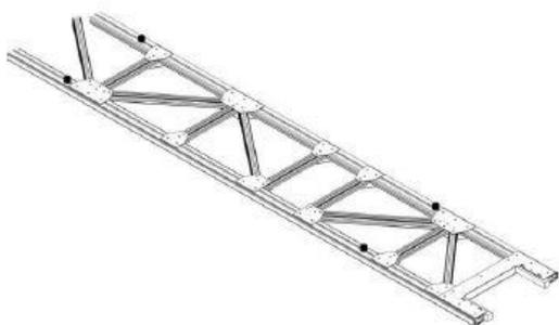
I tralici orizzontali sono formati da profili in acciaio zincato imbullonati e conferiscono la resistenza al vento del manto dimensionato in base alla zona di installazione e/o su richiesta specifica del cliente.
